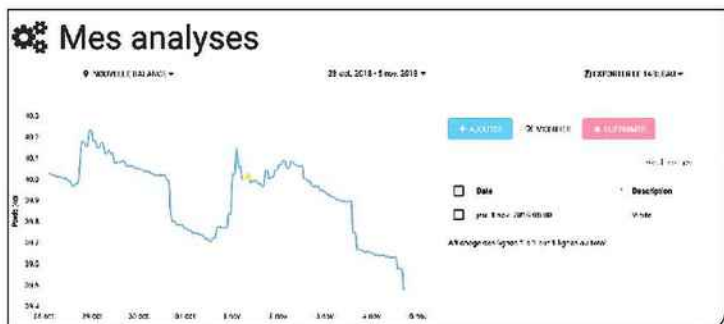
Grâce à la balance connectée Bee2Beep, il est possible de suivre en temps réel les variations de poids d'une ruche.
